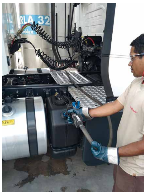
Os caminhões usam diesel S-10 e Arla 32, que reduzem em até 60% as emissões de Óxido de Nitrogênio (NOx)
