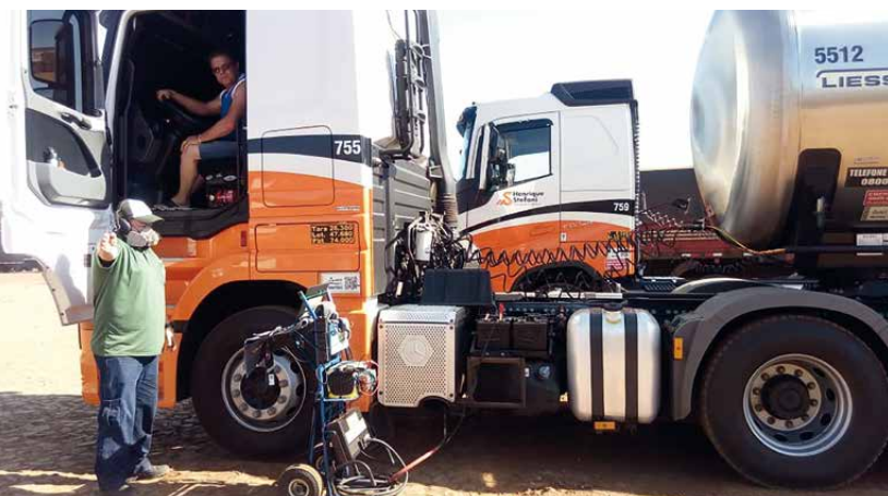
A aferição do veículo à Diesel é feita toda com base nas normas do Conselho Nacional de Meio Ambiente (Conama)
